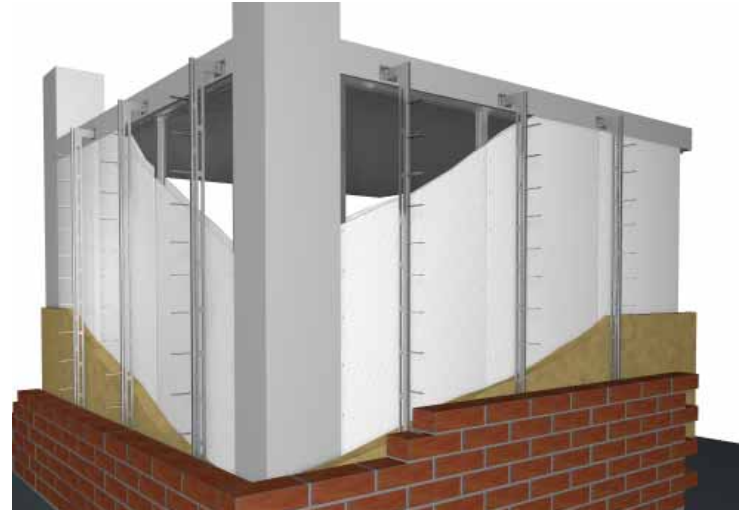
▲ Verankerung mit MOSO ® Windpostanker HV-WP
