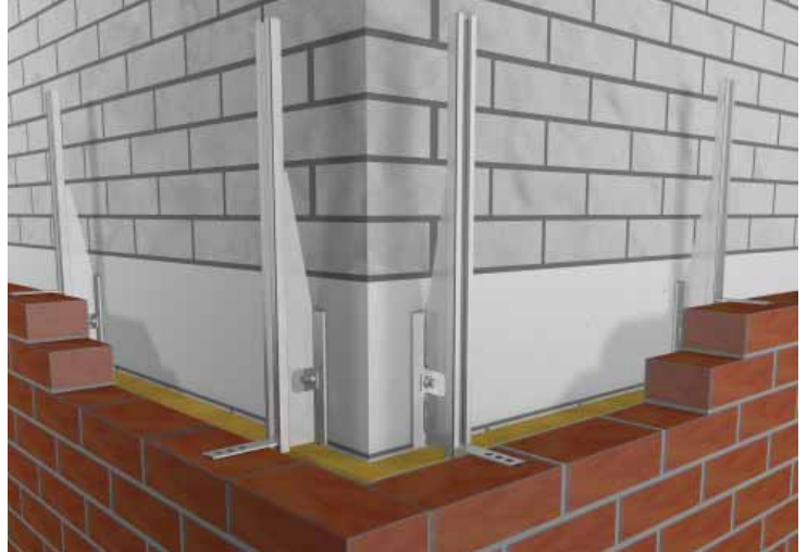
▲ Attikaverankerung mit MOSO® Horizontalverbindung HV-A
