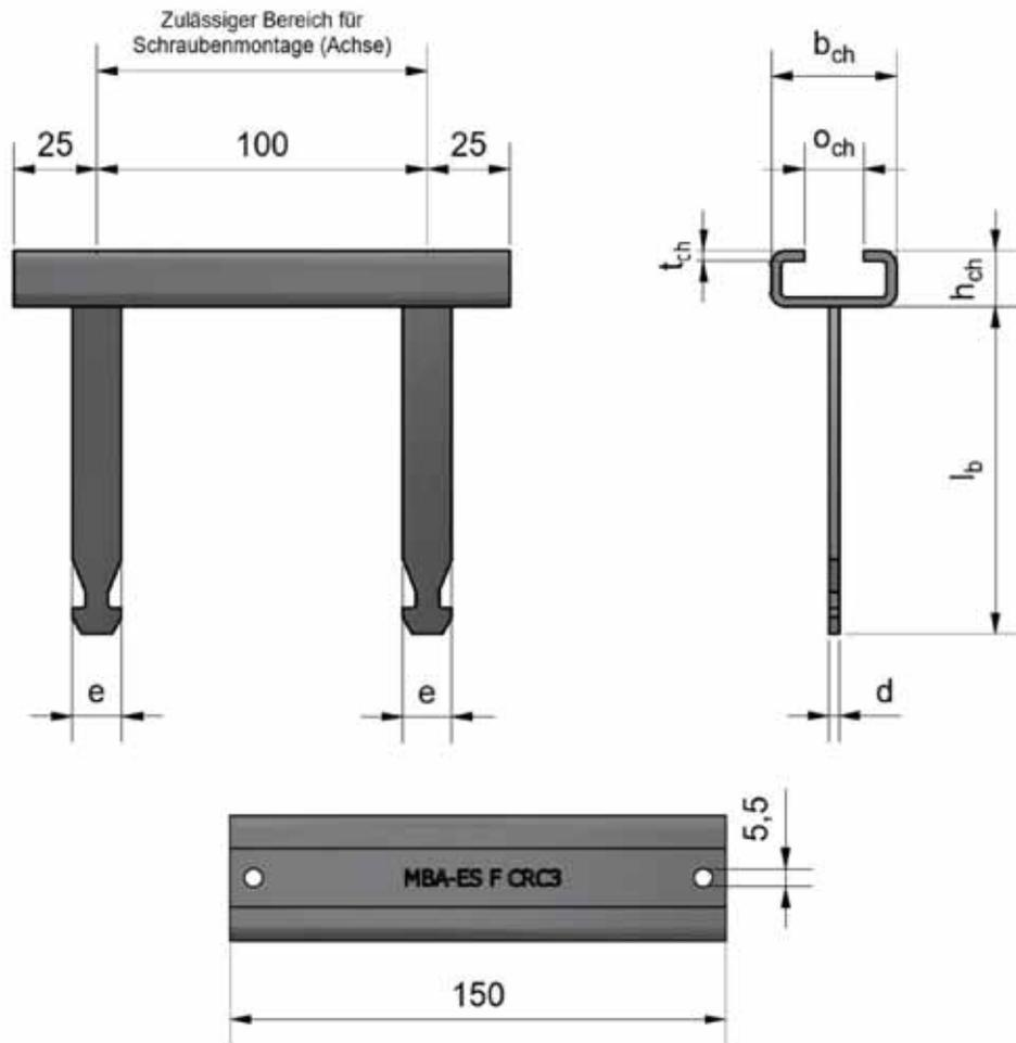
**Tabelle 3: Abmessungen Ankerschiene (Flachanker)**
