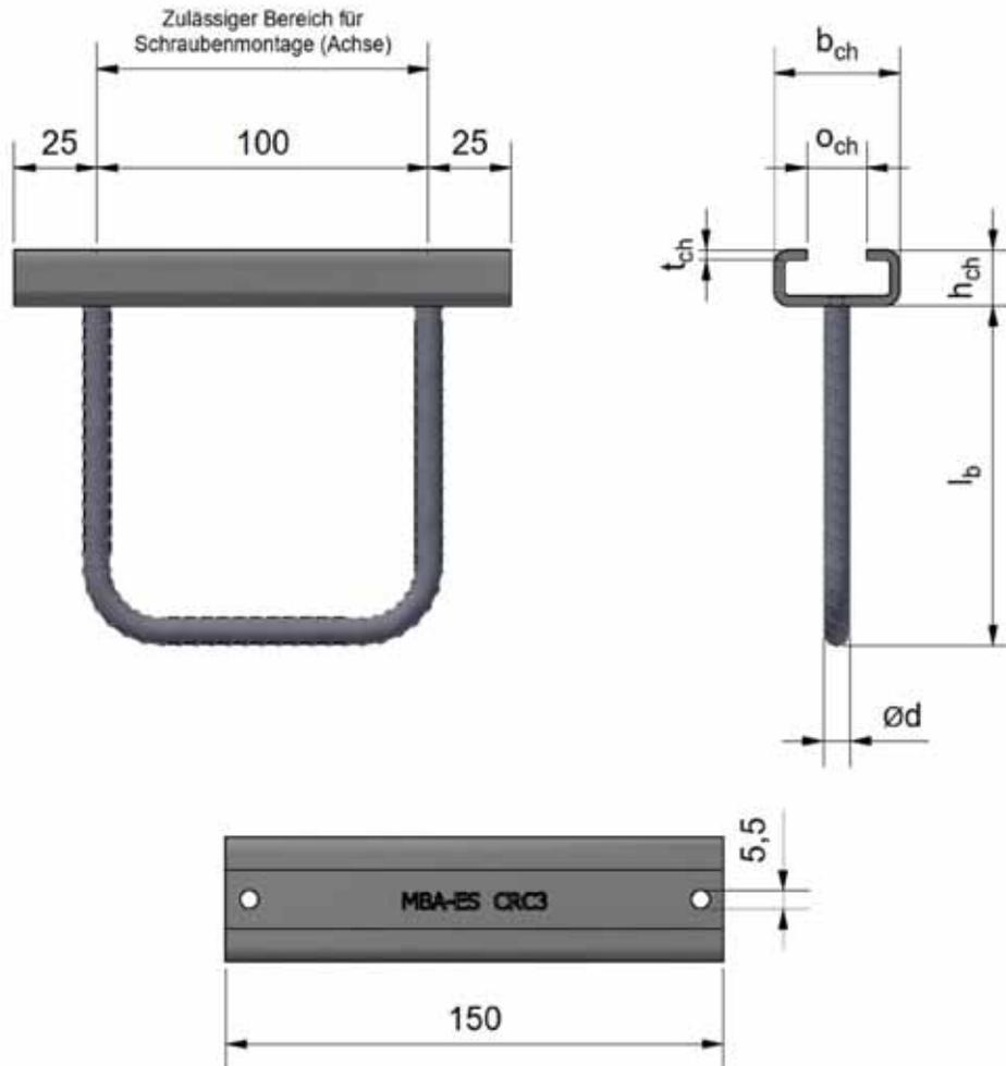
**Tabelle 1: Abmessungen Ankerschiene (Rundanker)**
