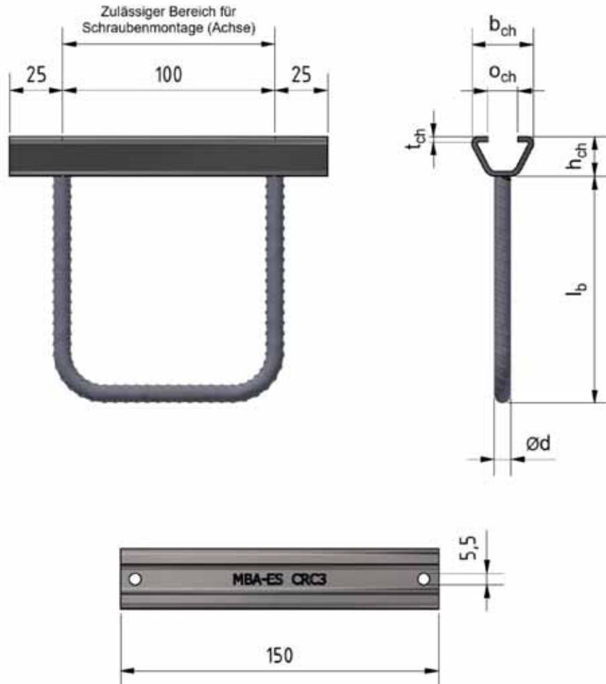
**Tabelle 4: Abmessungen Ankerschiene (Rundanker)**
