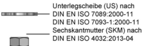
**Kennzeichnung der Halfen und Modersohn Spezialschraube, z.B.:**
