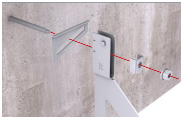
▲ Dübel nach Zulassung setzen. Keilscheibe und Traganker auf die Dübelankerstange aufsetzen...
