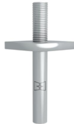
Der Stehbolzenanker dient zur Aufnahme von Vertikal- und Horizontallasten. Dieser zeichnet sich durch eine einfache Montage sowie eine sehr gute Justiermöglichkeit aus. Für die Aufnahme der thermischen Ausdehnung wird ein Stehbolzenanker elastisch umhüllt und lagert auf einem Elastomerlager.
